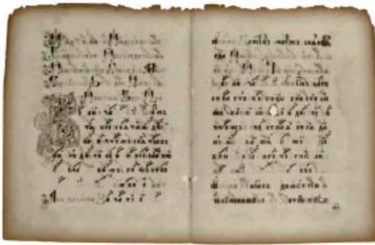
Страницы из «Обихода на крюковых по-тах» (сборник церковных песнопений, XIX век) с явными признаками коррозии железо-галловых чернил
