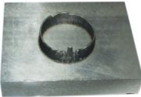
Стальной стакан, стенки которого «напечатаны» на металlopорошковом лазерном принтере
