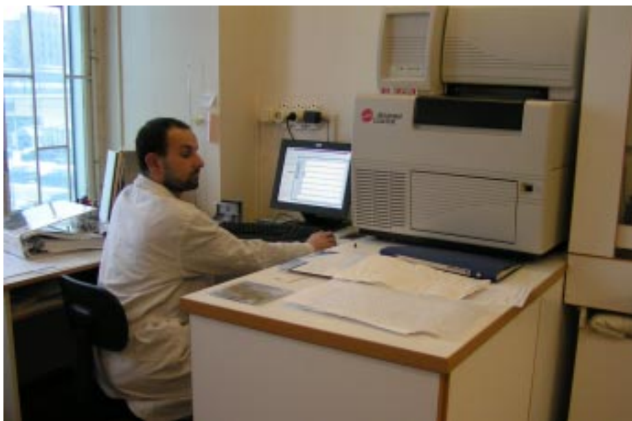
Секвенатор читает последовательность нуклеотидов в ДНК
